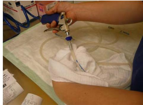
Abb. 8: Prüfung auf Trockenheit der Schläuche
