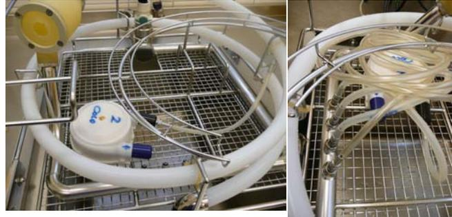
Abb. 5 und Abb. 6: Fördereinheit und Schläuche im RDG-E
